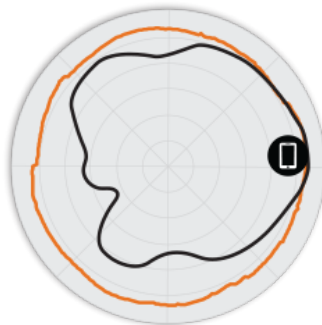
図 3. T350c/d 5GHz アジマス アンテナ パターン
