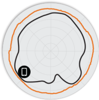
図 2. T350c/d 2.4GHz アジマス アンテナ パターン
