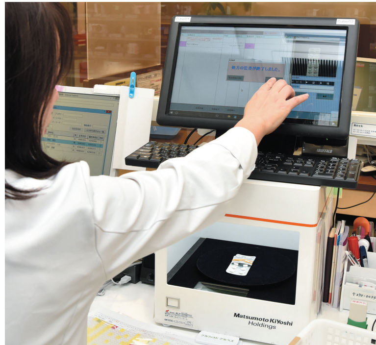
Cube.iは30cm×30cm×30cmの立方体(キューブ)。狭小スペースでも置けるコンパクトサイズ。PTPや包装のまま薬剤の向きや表裏を気にする必要がなく、きっちりと揃えなくても監査台に載せるだけで、薬剤監査、数量チェックが可能。
