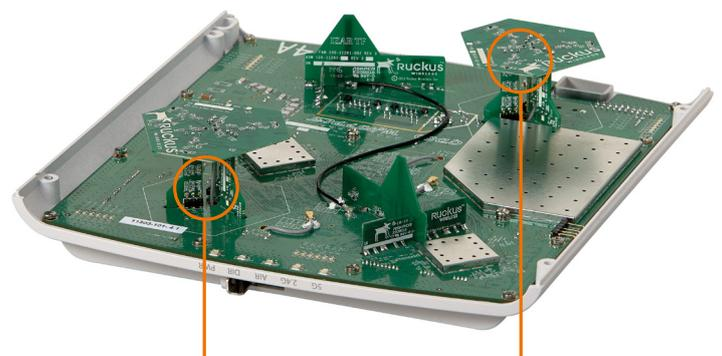
BeamFlex+ アダプティブ アンテナ技術
